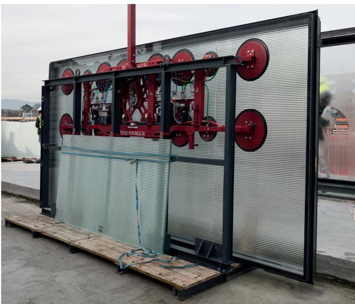
L'appareillage conçu spécialement pour la pose des briques de verre
