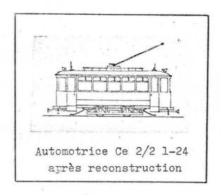
l'arrivée du nouveau matériel. Déjà vers 1930 on avait remplacé la roulette de la perche par un frotteur afin de diminuer les parasites radiophoniques. Des considérations pécuniaires avaient empêché l'introduction du pantographe à ce moment-là.
