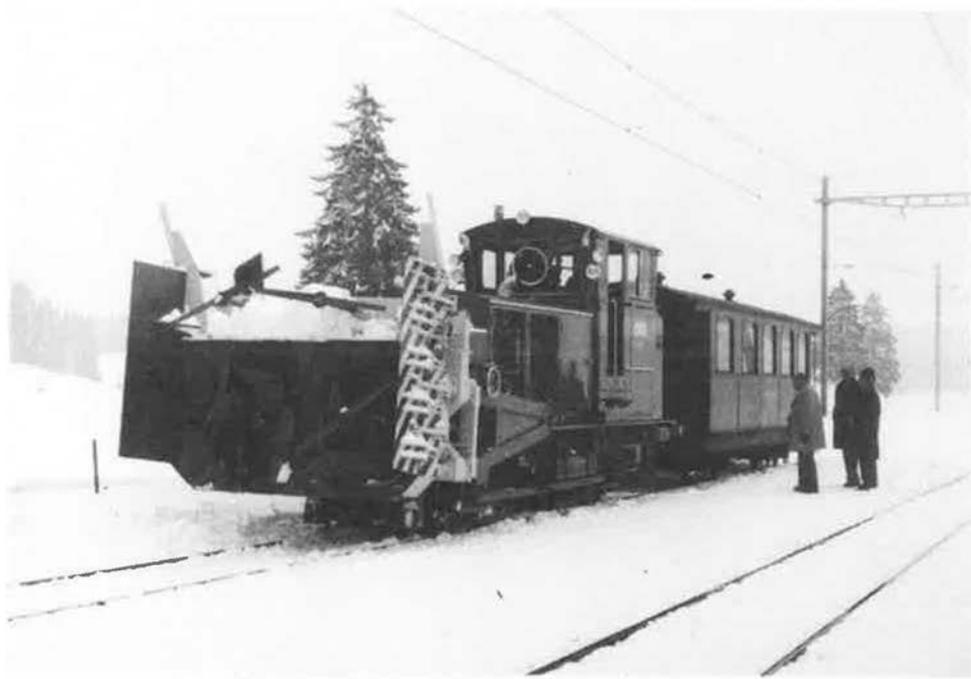
Néanmoins, le NStCM est la première compagnie suisse à être dotée d'un engin polyvalent unissant les qualités d'un chasse-neige rotatif et d'un véhicule-moteur autonome de service. Remarquons enfin que les plus gros engins "Beilhack" peuvent atteindre une puissance d'environ 1200 chevaux (turbines uniquement) et "avalent" 16.000 tonnes de neige à l'heure en déblayant une largeur utile de 4,75 mètres en un seul passage.
